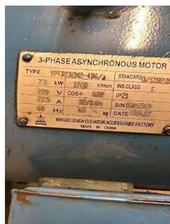
Motor elétrico máquina de tração
